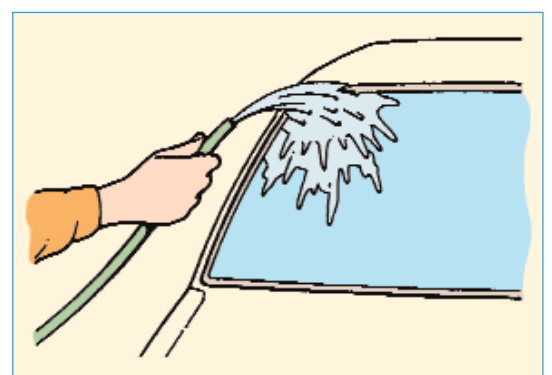
Σχήμα 13. Έλεγχος για εισροή νερού.
