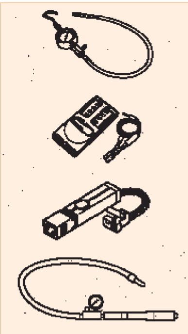
Σχήμα 7: Απαιτούμενα ειδικά εργαλεία για την αποσυναρμολόγηση - συναρμολόγηση εξωλέμβιας μηχανής.
