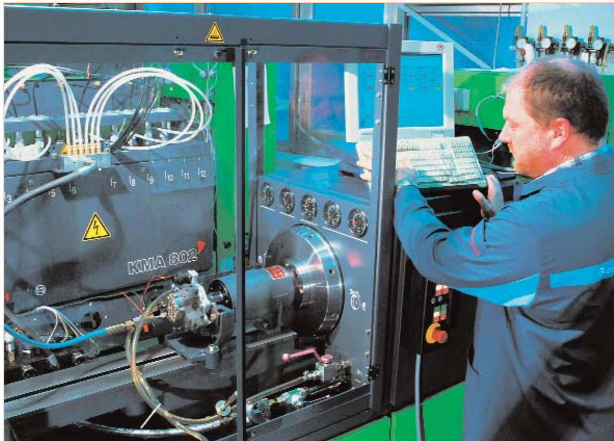
Έλεγχος υψηλής πίεσης συστήματος σε δοκιμαστήριο αντλιών.
