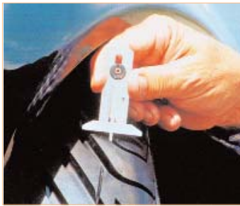
Μέτρηση βάθους πέλματος
