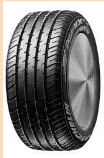
Ελαστικό υψηλών προδιαγραφών με δείκτη ταχύτητας (ZR) πάνω από 240 km/h.
