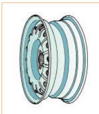
Σχήμα 2: Χαλύβδινη ζάντα σταθερά συνδεδεμένη και στερεωμένη στον δίσκο του τροχού.
