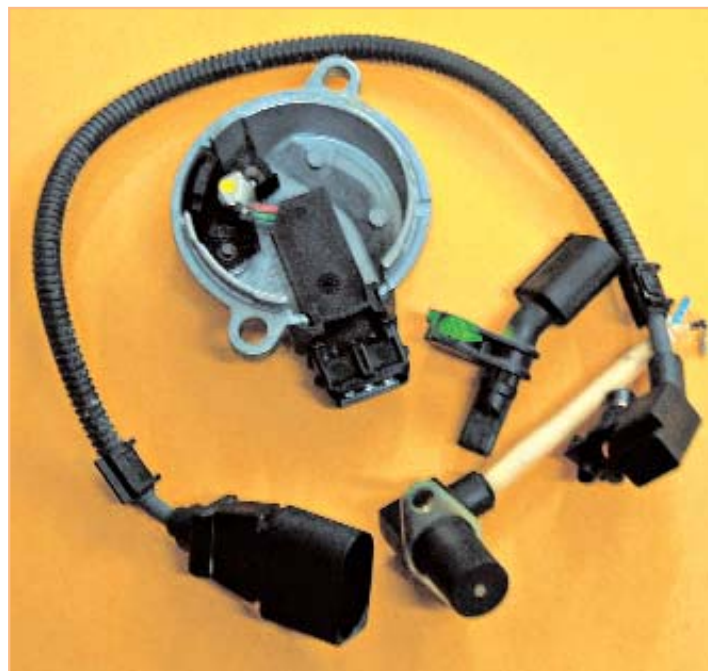
Σχήμα 4: Αισθητήρες στροφών κινητήρα και θέσης εκκεντροφόρου.
