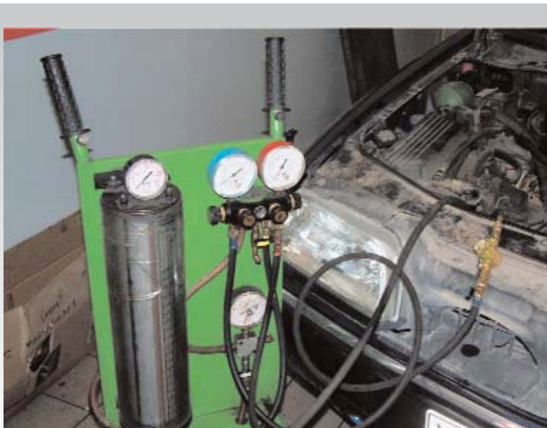
Σχήμα 2: Διάταξη οργάνων και αγωγών συσκευής πλήρωσης και αντλία κενού σε αυτοκίνητο.
