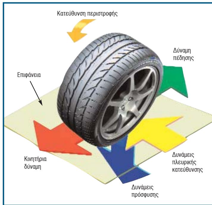
Σχήμα 3: Δυνάμεις που επενεργούν στον τροχό του αυτοκινήτου.
